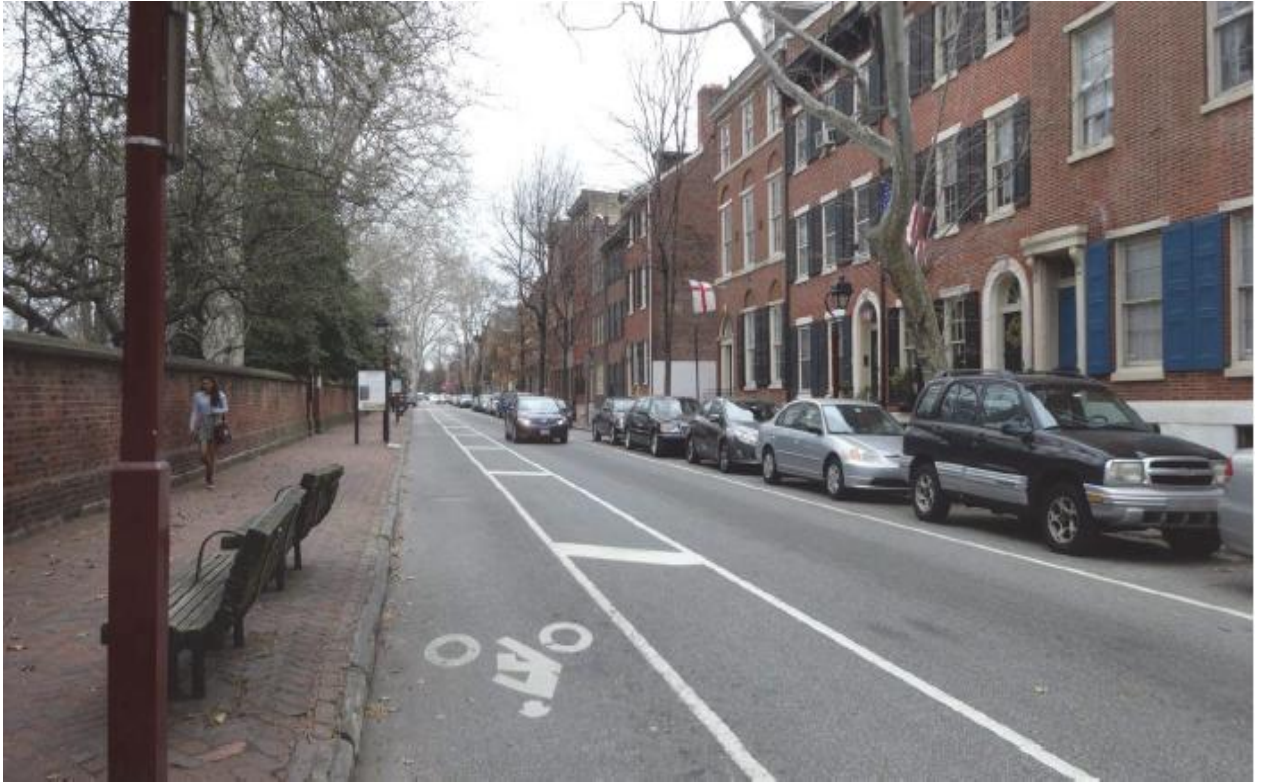
Σχήμα 25: Λωρίδα ποδηλάτου και προστατευτική νησίδα με απλή διαγράμμιση
