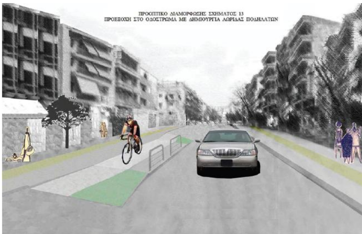
Σχήμα 11: Προεξοχή στο οδόστρωμα με δημιουργία λωρίδας ποδηλάτου
