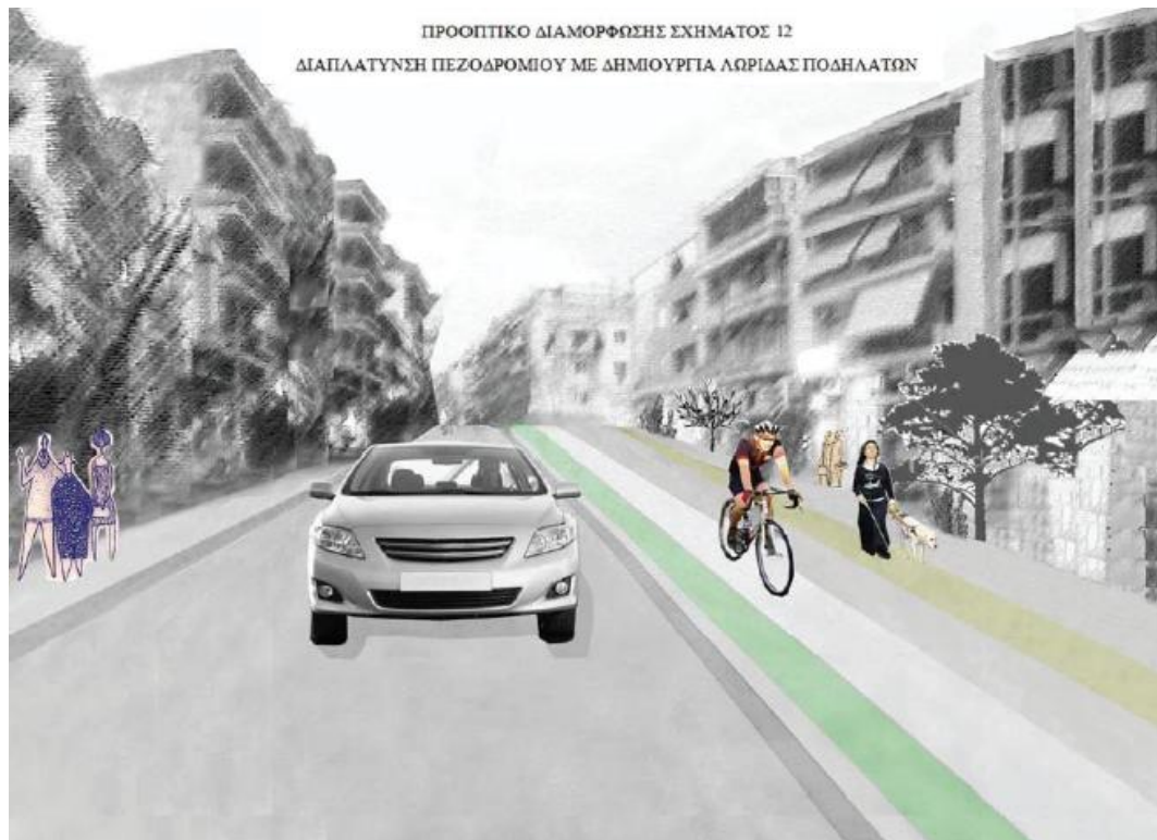
Σχήμα 21: Διαπλάτυνση πεζοδρομίου και δημιουργία λωρίδας ποδηλάτου
