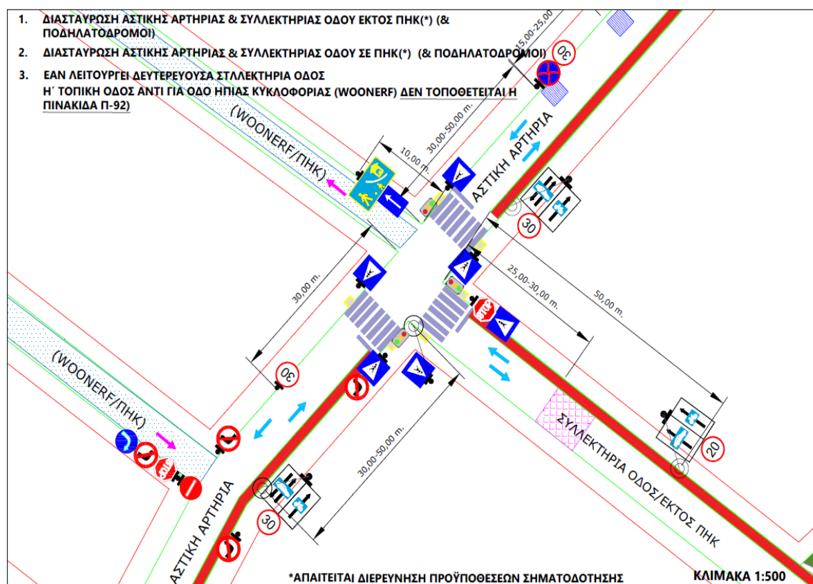
Σχήμα 6: Τυπική κατακόρυφη & οριζόντια σήμανση σε διασταυρώσεις αστικών αρτηριών με συλλεκτήριες οδούς (κύριες ή δευτερεύουσες) και τοπικές οδούς οι οποίες λειτουργούν -είτε όχι- ως οδοί ήπιας κυκλοφορίας οχημάτων (Woonerf) (& με λειτουργία ποδηλατοδρόμων)
