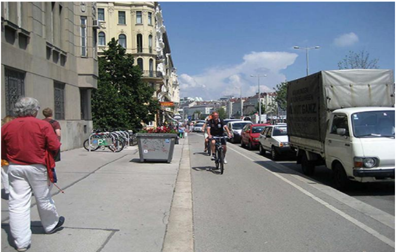
Σχήμα 24: Ποδηλατόδρομος μονής κατεύθυνσης στο επίπεδο του πεζοδρομίου
