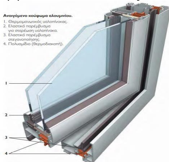
Εικόνα 14: Τομή ανοιγόμενου κουφώματος αλουμινίου με θερμοδιακοπή.
