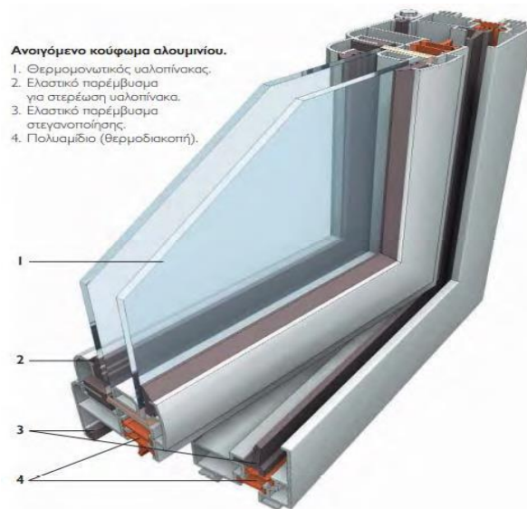
Εικόνα 16: Τομή ανοιγόμενου κουφώματος αλουμινίου με θερμοδιακοπή.
